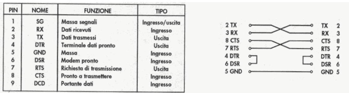
Figura 6: Schema dei collegamenti di un cavo nullmodem
